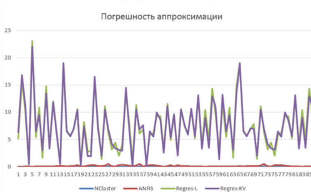
Рис. 7: Погрешности аппроксимации моделирования зависимости значений интенсивности спектральных линий от температуры задающего лазера
