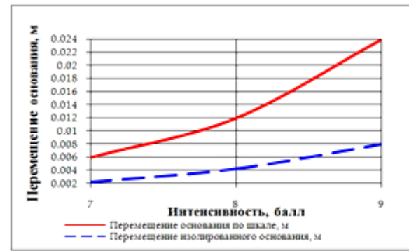
Рис. 4: Зависимость между смещением ростверка и интенсивностью землетрясений при высокочастотном колебании
