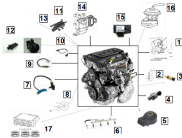
Рис. 1: Система управления двигателем. Основные компоненты объекта исследования: 1 - дроссельная заслонка; 2 - клапан принудительной вентиляции картера; 3 - датчик охлаждения; 4 - датчик давления масла; 5 - датчик детонации; 6 - топливные инжекторы; 7 - датчик положения коленчатого вала; 8 - датчик положения коленчатого вала; 9 - кислородный датчик; 10 - датчик положения распределительного вала; 11 - обратный клапан топливной системы; 12 - датчик массового расхода воздуха; 13 - датчик температуры воздуха; 14 - модуль зажигания и катушки; 15 - датчик абсолютного давления; 16 - клапан рециркуляции выхлопных газов; 17 - электронный блок управления.
